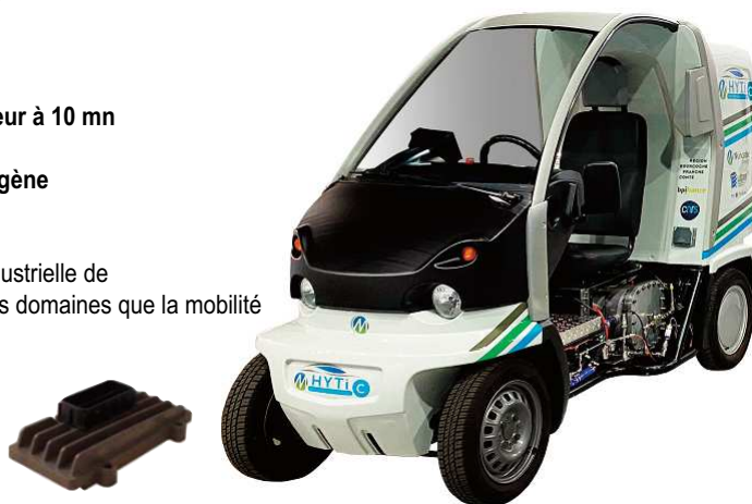
Système RMS de management des réservoirs (état de SOC, gestion thermique, gestion débit, ...)
