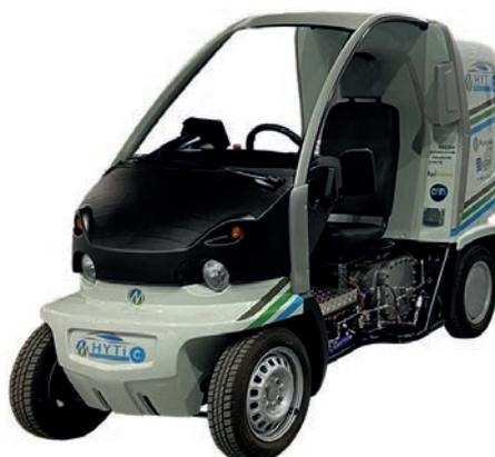
encore d'engins de chantiers. Le véhicule MHYTiC de MINCATEC Energy démontre la capacité de réaliser 180 km grâce à 1 kg d'hydrogène, rechargeable en moins de 10
